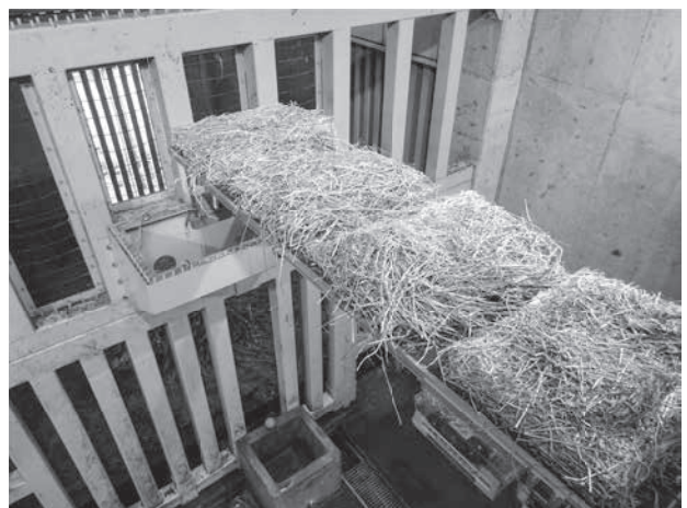
図6 ベルトコンベア上に餌4回分をセットした様子
